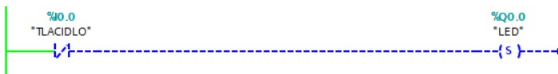
Obr. 3.23. Prvý príklad výstupu rozpínacieho kontaktu
