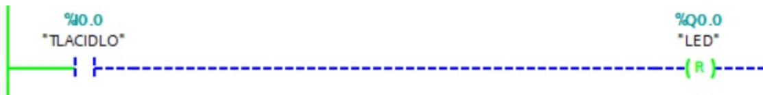
Obr. 3.48. 1. fáza animácie programu s inštrukciou RESET
