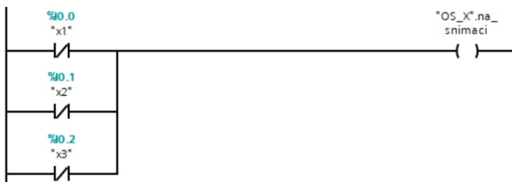
Obr. 4.167. Vytvorenie signálu na snímači
