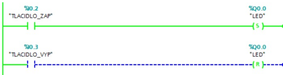
Obr. 3.52. 2. fáza animácie ovládania výstupu (LED)
