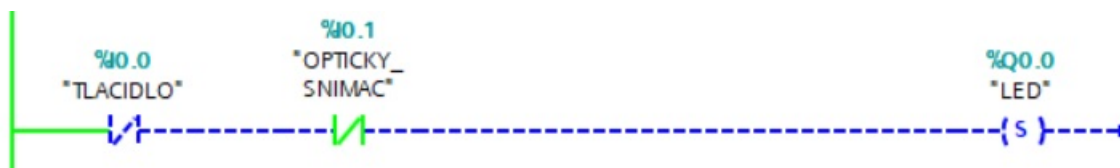
Obr. 3.25. Príklad neplatnej podmienky AND
