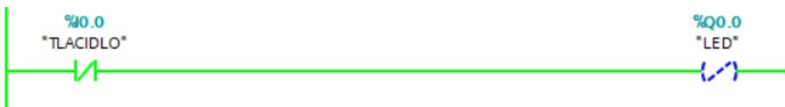
Obr. 4.46. Príklad ovládania výstupu LED - výstup nie je aktivovaný
