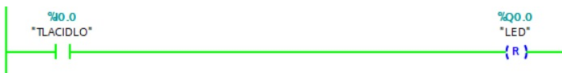
Obr. 3.49. 2. fáza animácie programu s inštrukciou RESET
