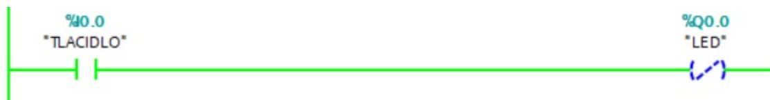
Obr. 3.33. Príklad použitia inštrukcie negované priradenie
