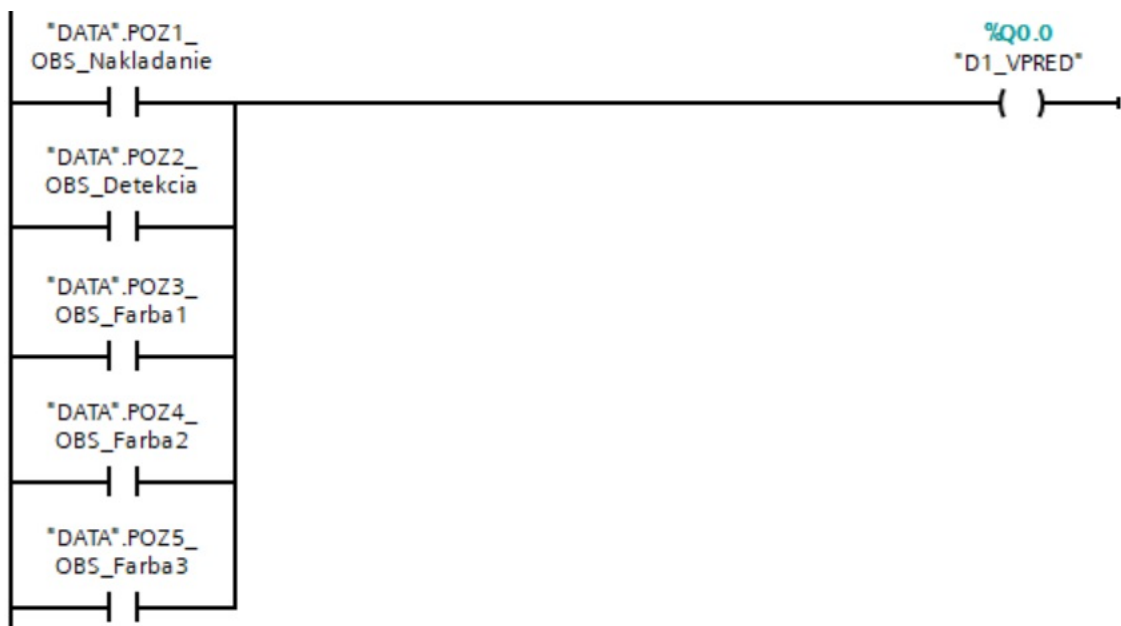
Obr. 4.155. Implementácia ovládania dopravníka
