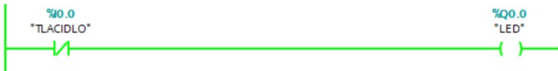
Obr. 4.51. Príklad ovládania výstupu LED - výstup je aktivovaný
