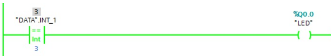
Obr. 3.172. 2. príklad inštrukcie rovný
