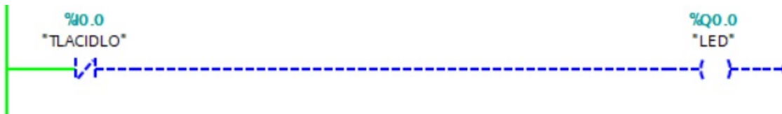
Obr. 4.50. Príklad ovládania výstupu LED - výstup nie je aktivovaný
