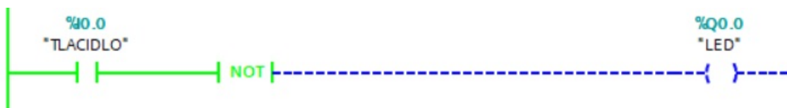
Obr. 3.37. Príklad animácie inštrukcie invertovanie stavu RLO
