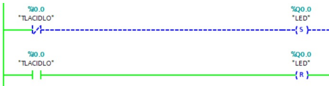
Obr. 4.52. Príklad ovládania výstupu LED - výstup nie je aktivovaný
