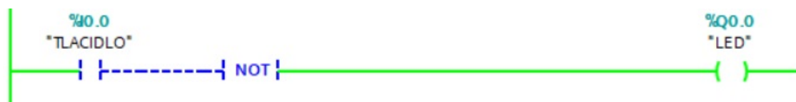
Obr. 3.38. Príklad animácie inštrukcie invertovanie stavu RLO
