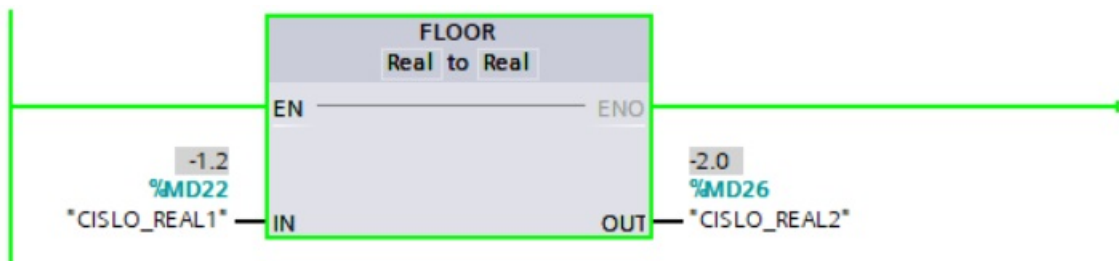
Obr. 3.97. 2. príklad použitia inštrukcie FLOOR
