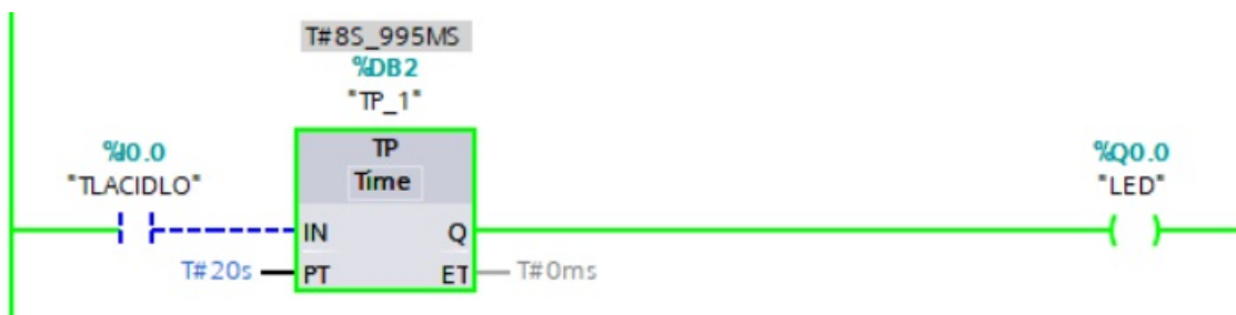
Obr. 3.216. 3. fáza monitorovania stavov inštrukcie TP
