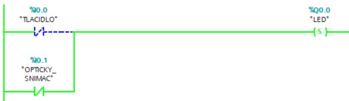
Obr. 3.26. Príklad platnej podmienky OR
