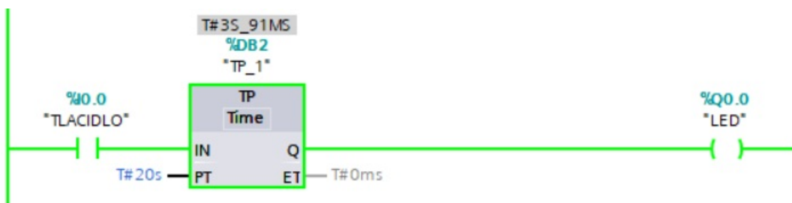
Obr. 3.215. 2. fáza monitorovania stavov inštrukcie TP
