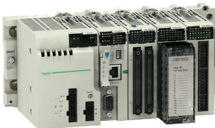
Obr. 1.4. Fotografia modulárneho PLC Modicon M340
