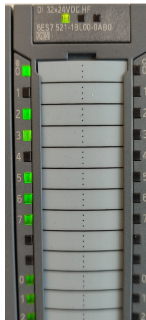
Obr. 4.10. Príklady stavov digitálnych vstupov
