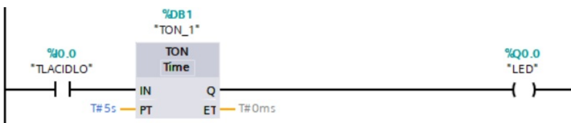
Obr. 4.28. Príklad analýzy programu v LD
