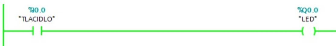
Obr. 4.45. Príklad ovládania výstupu LED - výstup je aktivovaný
