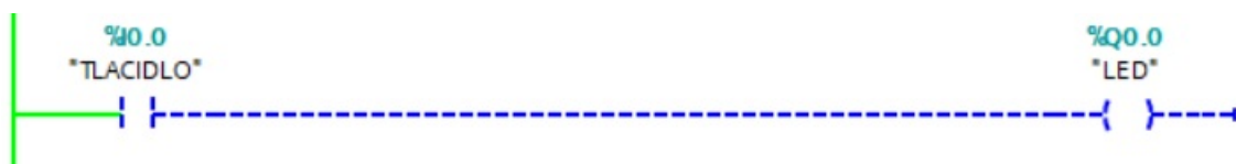
Obr. 4.44. Príklad ovládania výstupu LED - výstup nie je aktivovaný
