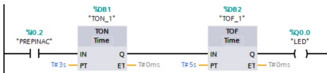
Obr. 4.42. Príklad analýzy programu v LD
