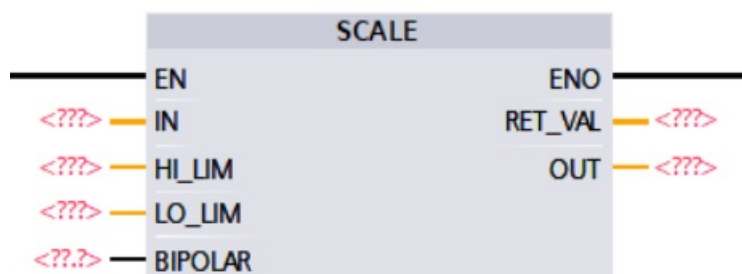
Obr. 3.106. Symbol inštrukcie SCALE
