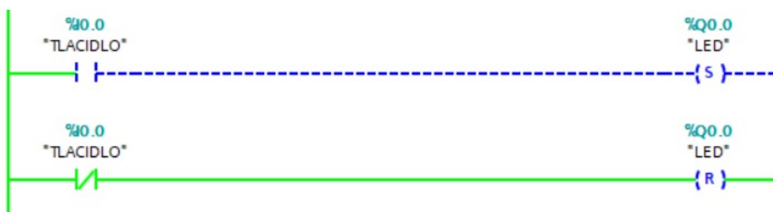
Obr. 4.48. Príklad ovládania výstupu LED - výstup nie je aktivovaný
