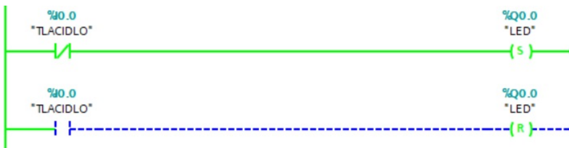
Obr. 4.53. Príklad ovládania výstupu LED - výstup je aktivovaný
