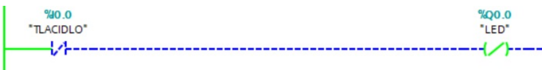
Obr. 4.47. Príklad ovládania výstupu LED - výstup je aktivovaný
