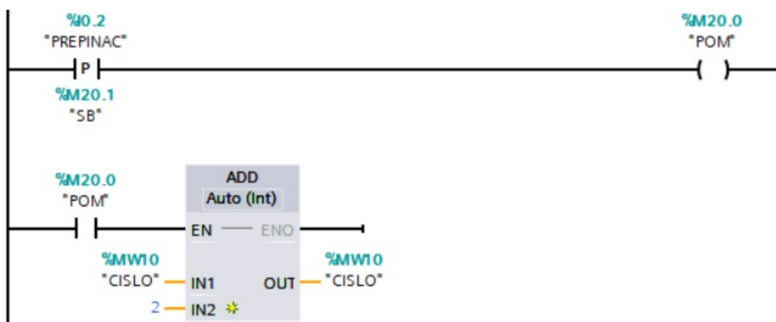
Obr. 4.23. Príklad analýzy programu v LD
