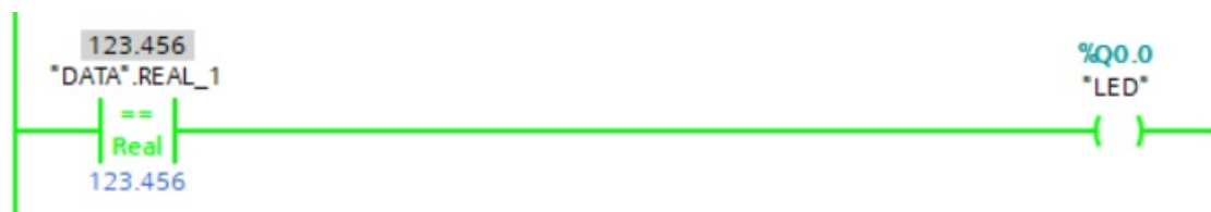
Obr. 3.173. 3. príklad inštrukcie rovný
