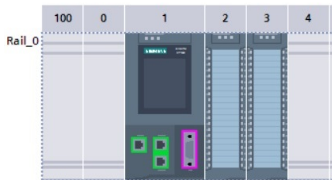
Obr. 4.7. Hardvérová konfigurácia S7-1500
