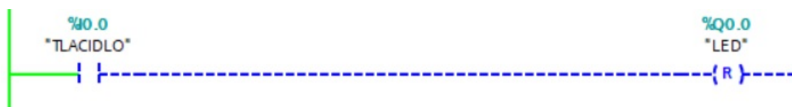
Obr. 3.50. 3. fáza animácie programu s inštrukciou RESET
