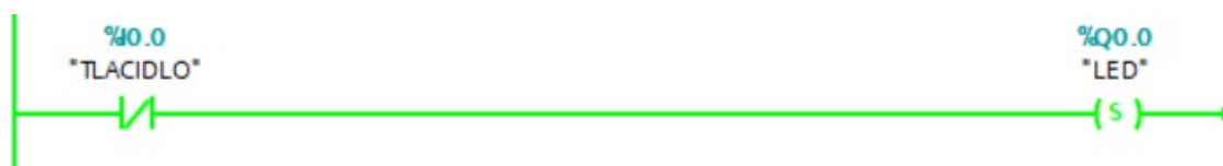
Obr. 3.24. Druhý príklad výstupu rozpínacieho kontaktu
