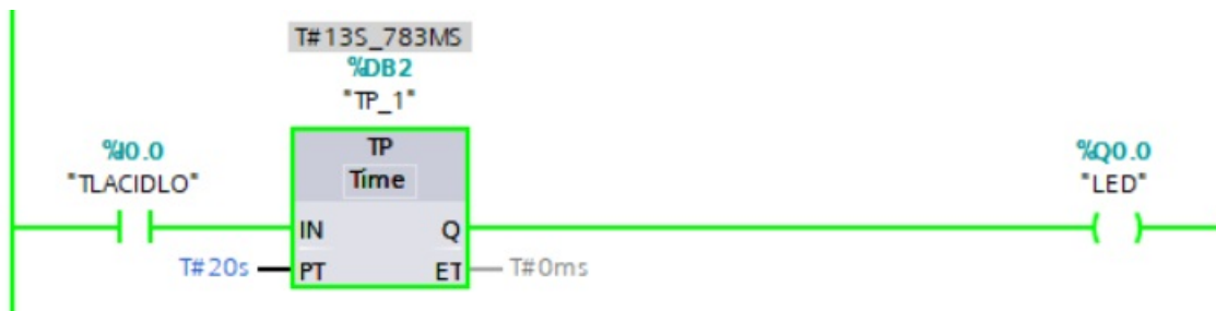
Obr. 3.217. 4. fáza monitorovania stavov inštrukcie TP
