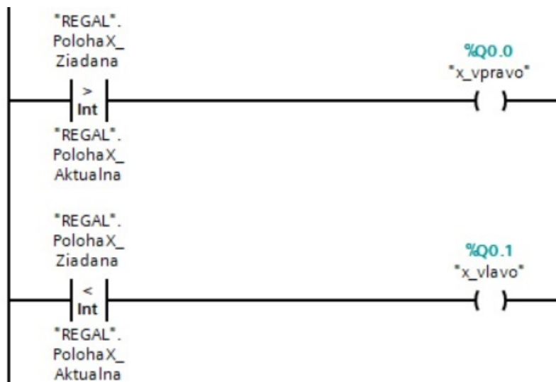
Obr. 6.15. Zadanie 6 - analýza programu (Network 2)
