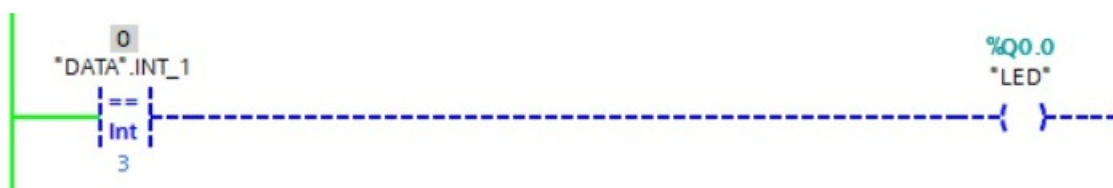
Obr. 3.171. 1. príklad inštrukcie rovná sa
